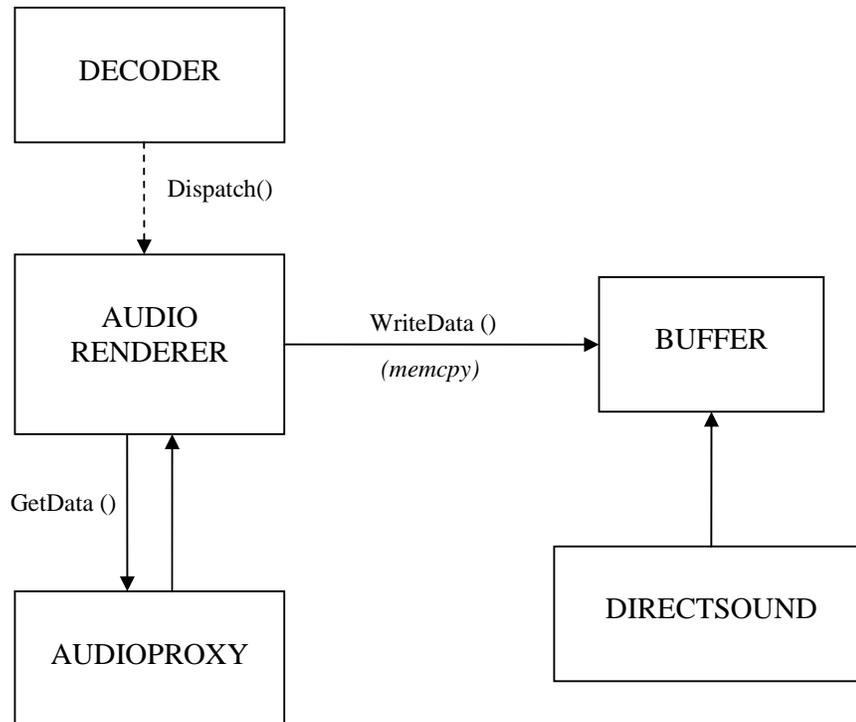
Un'altra funzione dell'Audio Renderer è quella di settare i parametri della struttura dati WAVEFORMATEX, presente all'interno delle DirectSound. Tale struttura dati descrive i parametri dei file audio (in formato .wav) che dovranno essere riprodotti dalla scheda audio: essi vengono settati in conseguenza dei dati letti dai vari decoder.
