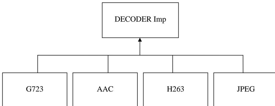
Ciascun decoder esistente, e ciascun nuovo decoder che si intende creare, deve ereditare dalla classe DecoderImp presente all'interno del progetto: si tratta di una classe virtuale che fornisce una implementazione di default dei metodi del decoder; si richiede ovviamente al programmatore di
