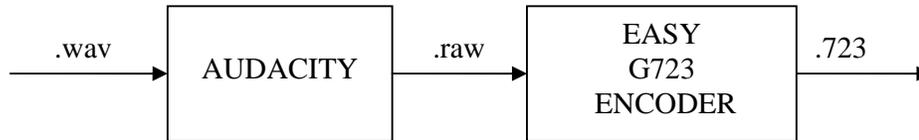
Audacity e EasyG723Encoder sono i due software che sono stati utilizzati per generare, a partire da un file .wav stereo, e passando per il formato .raw, un file audio stereo nel formato G723.
