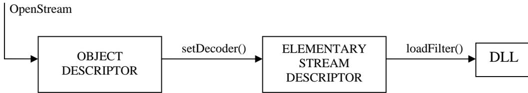
Al momento dell'apertura dello stream, vengono analizzati i vari Object Descriptor che lo compongono; si richiede che ciascun ES Descriptor fornisca le informazioni necessarie a caricare il decoder giusto per il file da decodificare e riprodurre. Sempre per mezzo dell'Elementary Stream Descriptor viene effettuata l'operazione di loadFilter() che provvede al caricamento della DLL che verrà utilizzata a run-time.
