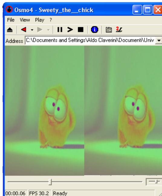
L'immagine mostra un ulteriore problema: i pixel vengono visualizzati con una sfumatura tendente al verde. Dopo aver riflettuto ed analizzato le varie componenti del software, siamo indotti a pensare che l'inconveniente sia dovuto alla non corretta compilazione delle librerie FFmpeg.
