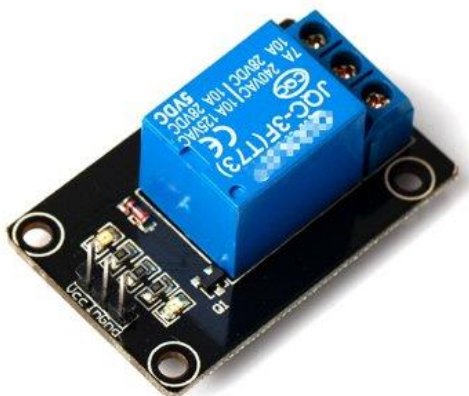
Figura 26 : PCB ospitante il relè dedito all’azionamento del perno usato per l’aggancio/sgancio della bicicletta alla rastrelliera
