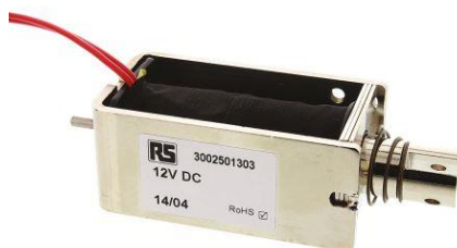
Figura 27 : Solenoide a D in c.c. A spinta BLP 42-120-621-620, corsa massima 27mm, tensione 12 V c.c., 10W
