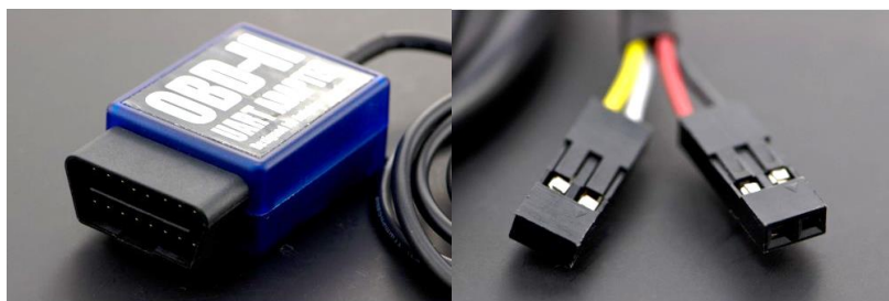
Figura 45 : UART Adapter per CanBus Sniffer
