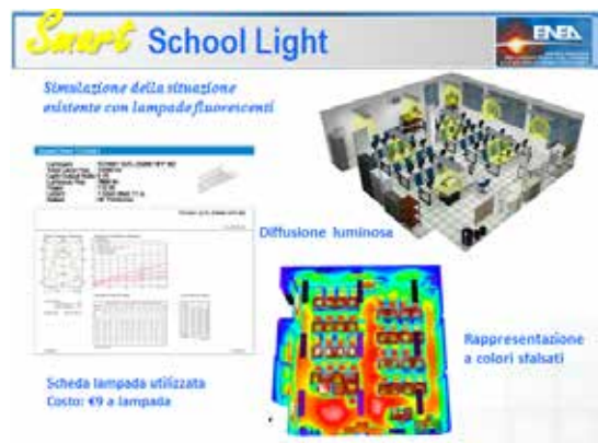
Fig. 3 Simulazione della situazione esistente con lampade fluorescenti
