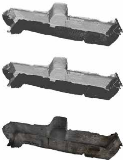
Fig. 4 Steps processuali nella creazione del modello tridimensionale (nuvola di punti, mesh, modello texturizzato)
