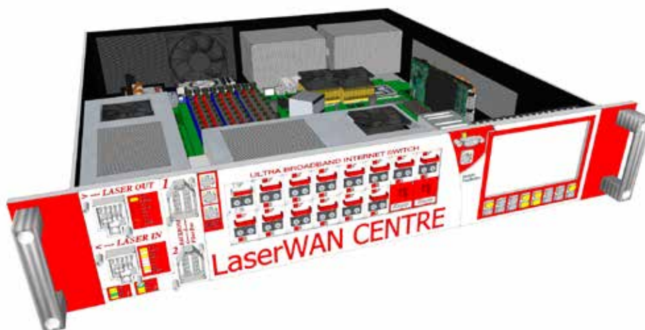
Fig. 5 Disegno del dispositivo di interfaccia LaserWAN Centre
