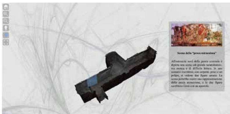
Fig. 5 Modello tridimensionale inserito in 3DHOP con funzione hotspot per l'inserimento e la visualizzazione di metadati
