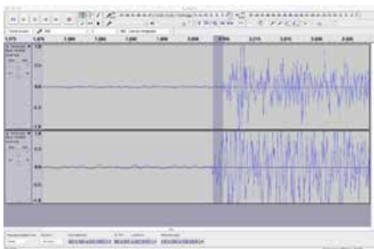
Fig. 3 Il ritardo della trasmissione audio: delay misurato nella configurazione “back to back” (zoom sul tempo 2±1ms)
